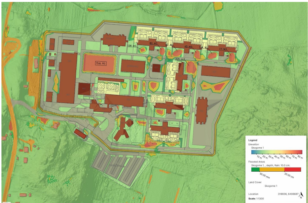
Figur 33. Översvämningsytor dimensionerade för ett skyfallsscenario.
