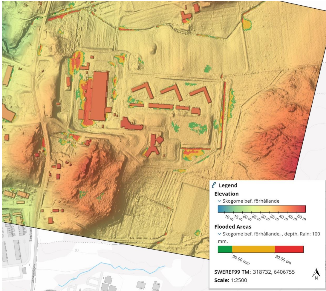
Figur 13. Vattendjup i vattensamlingar som bildas av ett 100 års regn, befintliga förhållanden. Figur skapad i SCALGO.
