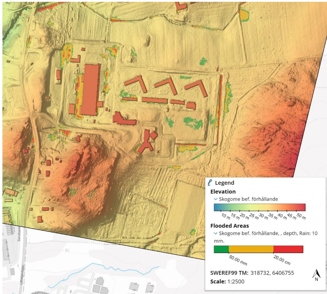
Figur 12. Vattendjup i vattensamlingar som bildas av ett 10 års regn, befintliga förhållanden. Figur skapad i SCALGO. Grönt område: 0-5 cm, Gult område: 5-20 cm, Rött område: >20 cm
