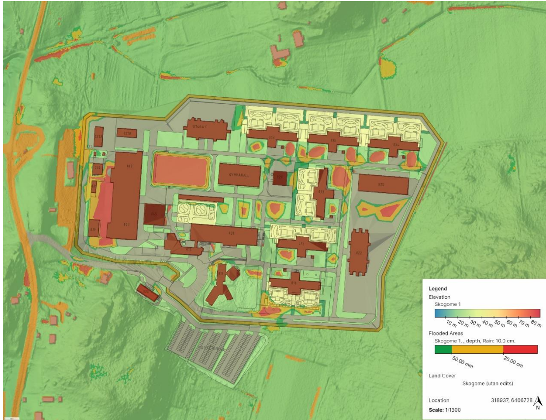
Figur 19. Vattendjup i respektive vattensamling vid ett 100 års regn. Figur skapad i SCALGO. Grönt område: 0-5 cm, Gult område: 5-20 cm, Rött område: >20 cm
