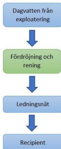
Figur 10. Systemprincipen för föroreningsberäkningarna.
