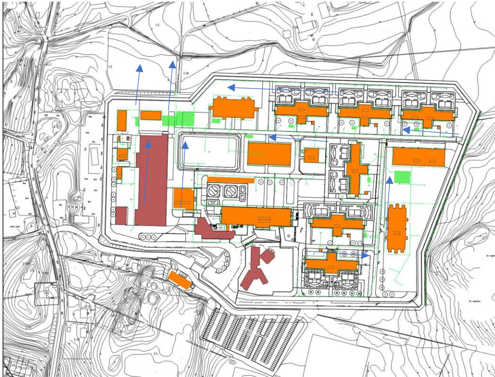
Figur 28. Föreslagen lösning för dagvattenhantering innanför perimeterskyddet med pilar som redovisar flödesriktning.
