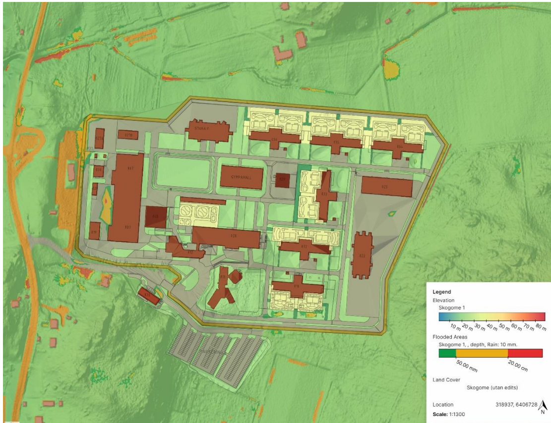
Figur 16. Vattendjup i vattensamlingar som bildas av ett 10 års regn, efter om- och tillbyggnad. Figur skapad i SCALGO. Grönt område: 0-5 cm, Gult område: 5-20 cm, Rött område: >20 cm
